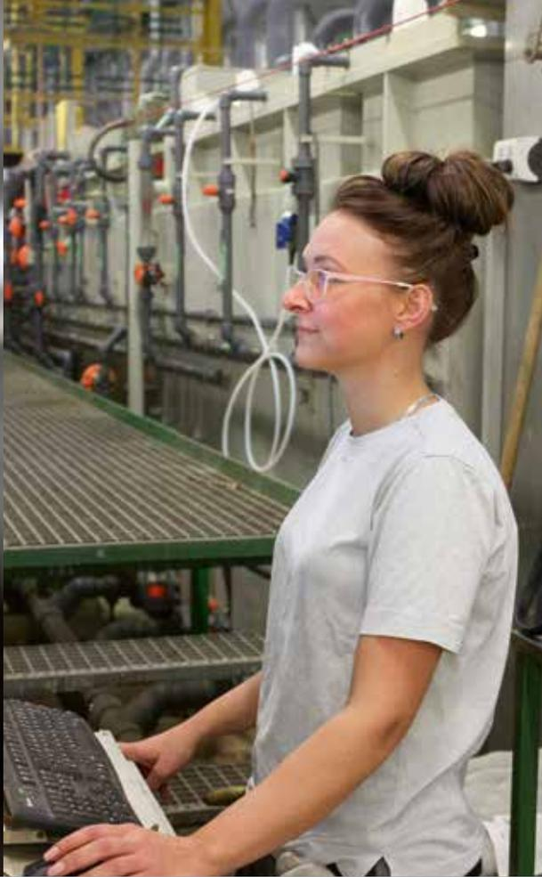
Leitrechnersteuerzentrale für Verchromungsanlage
