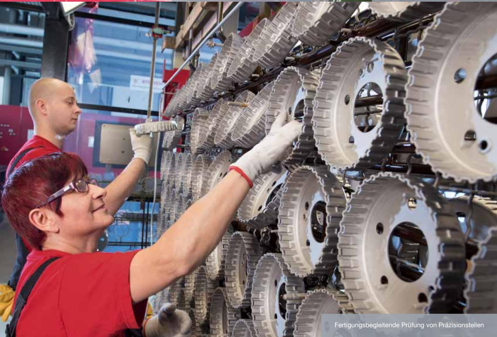
Fertigungsbegleitende Prüfung von Präzisionsteilen
